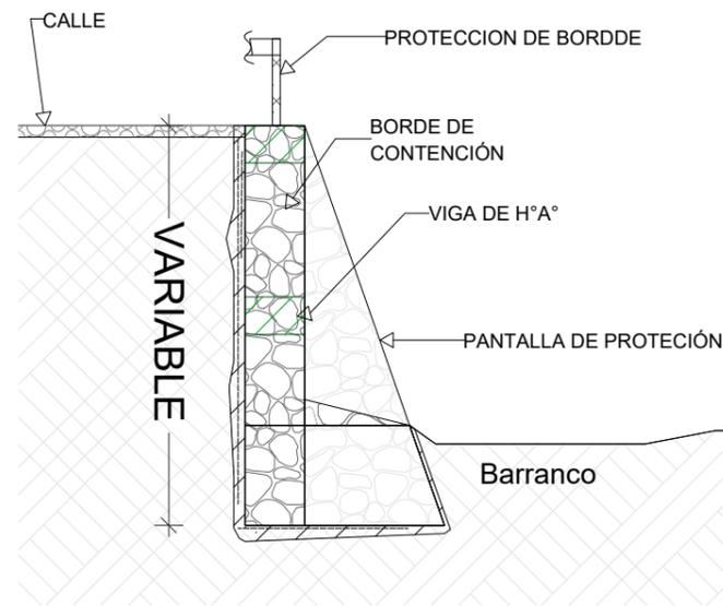
**DETALLE MURO DE CONTENCIÓN**
